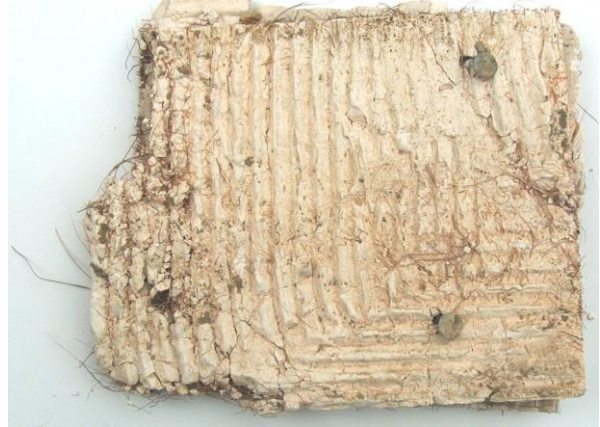
Voorbeeld van een stuk pleisterplaat, versterkt met paardenhaar.
